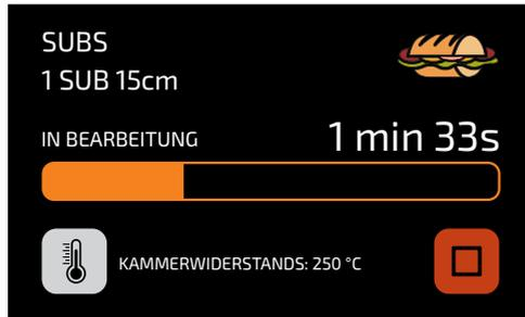
f) Wenn die Gerätetür geöffnet wird, wird der Betrieb angehalten; Nach dem Schließen der Tür wird der Betrieb durch Drücken der Taste fortgesetzt
