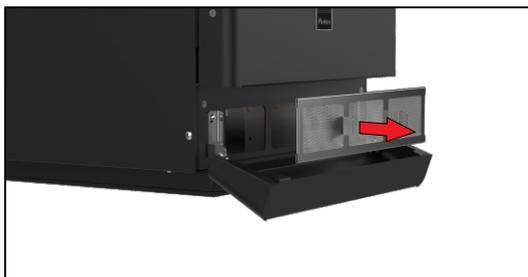
c) Zur korrekten Desinfektion den Filter in lauwarmem Wasser mit einem milden Reinigungsmittel einweichen.
