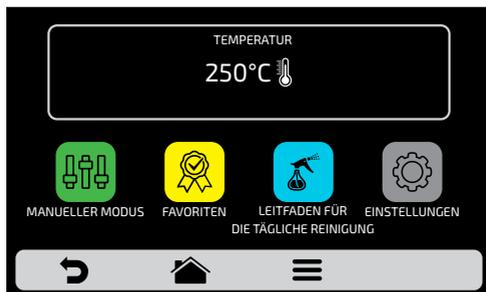
c) Stellen Sie die Parameter Zeit, Temperatur, Heißluftgeschwindigkeit und Mikrowelle ein.
